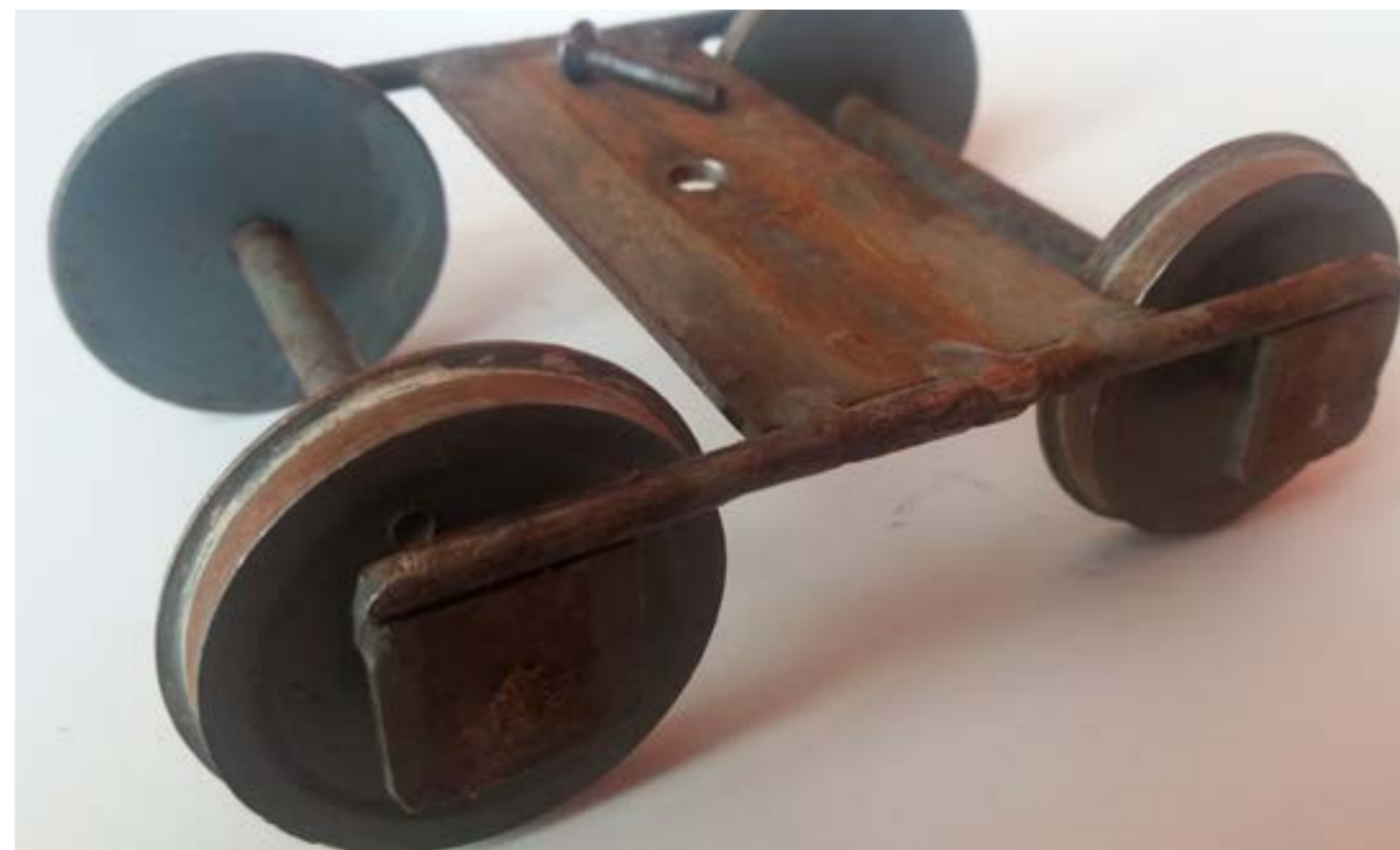
"Para asegurarme que rodara bien hice el alma de los bogies de hierro."
