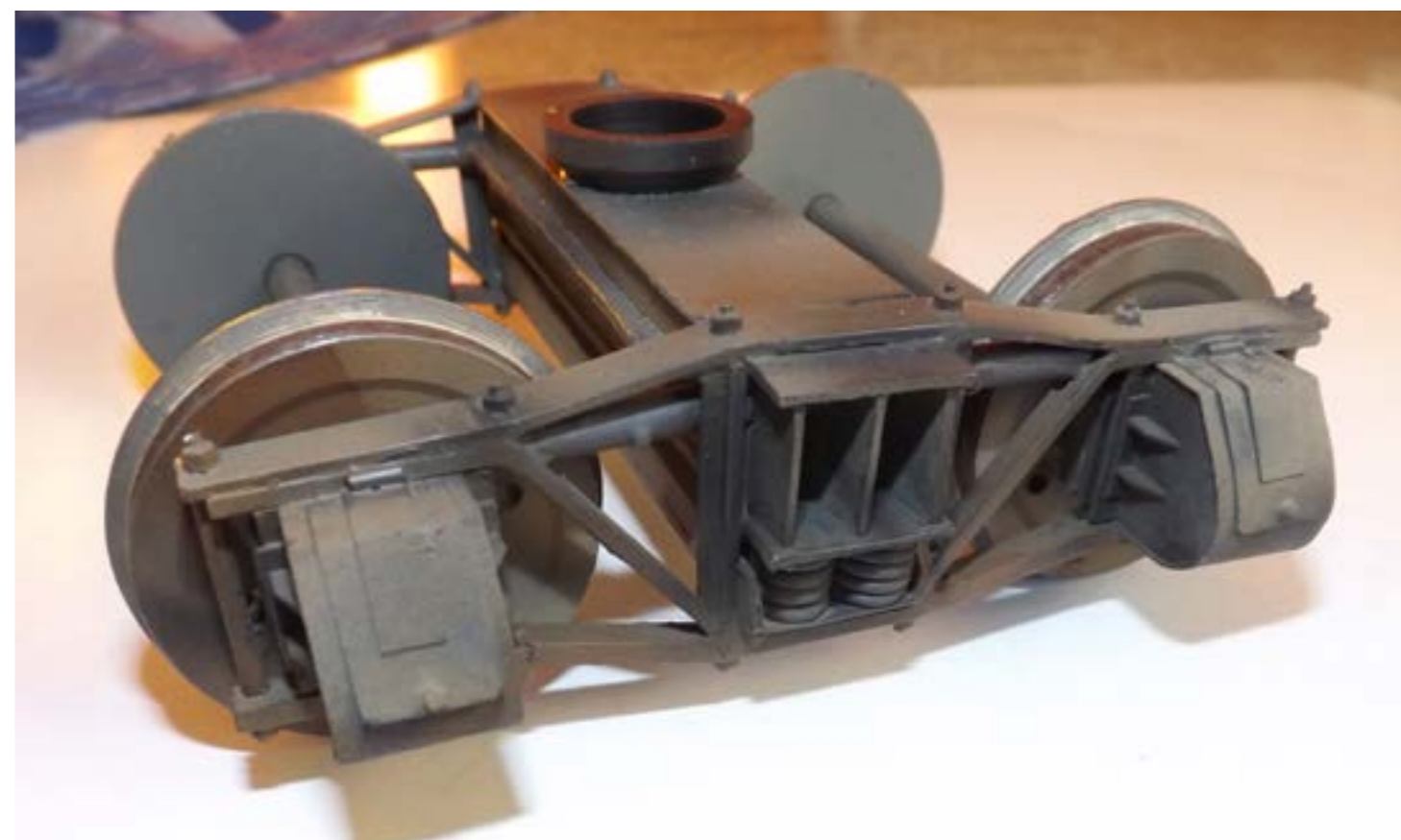
"Luego con estireno y madera fui cubriendo el alma para aproximarme a la forma verdadera del bogie."
